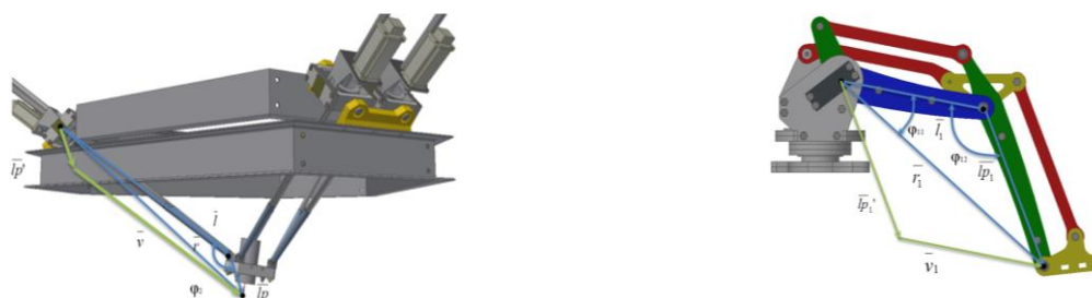
Рисунок 1 – Паралелограм, що формується при введенні вимірювального контуру в перерізі штанги верстата ПК (а) та маніпулятора з двома ступенями вільності (б).
