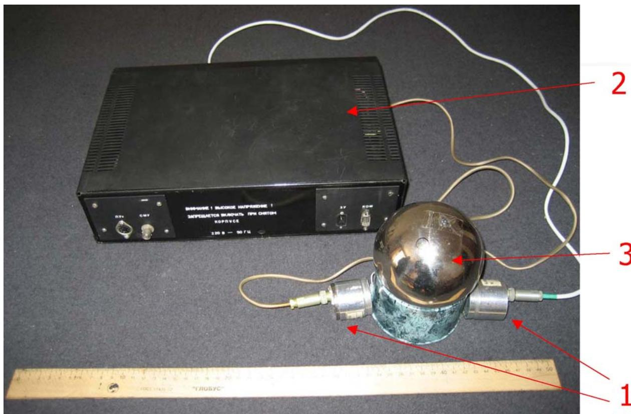
Рис. Д.2. Фотография установки для определения направления на точечный источник излучения:
