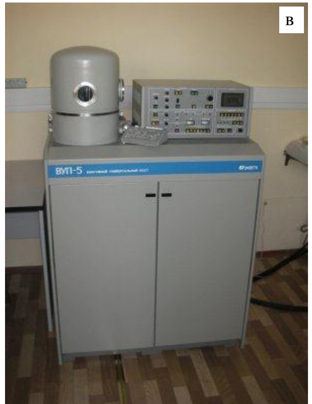
Рис. 2.1. Зовнішній вигляд високовакуумної установки (а), комбінованого насосу HiCube 80 Classic з HiRace 80 (б) та установки ВУП-5М (в)
