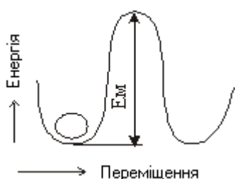
Рис. 4.8. Зміна енергії атома при переміщенні його у вакантний вузол
