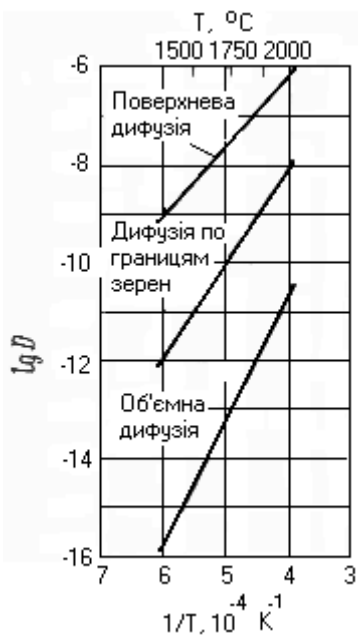
Рис. 6.4. Зерногранична дифузія в алюмінії
