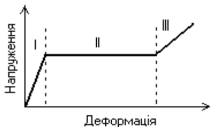
Рис. 15.6. Залежність напруження від деформації для кристалічного лінійного полімеру
