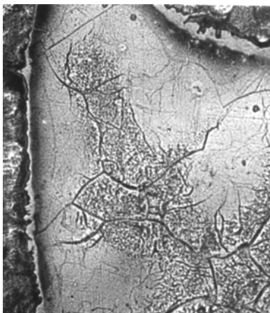
Рисунок 3.39 – Мікроструктура (x200) з'єднання сталі 20 сплавом Cu-Mn з наповнювачем із суміші нікелю й низьковуглецевої сталі
