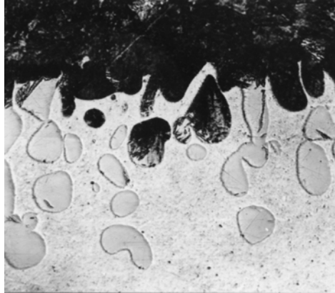
Рисунок 3.33 – Мікроструктура (x100) металу шва в поверхні високовуглецевої частинки з залізонікелевого композиційного наповнювача після взаємодії з розплавом латуні при T_p 980°C, 60 хв
