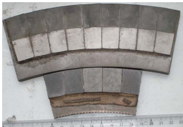
Рисунок 4.21 – Фрагменти лопаті шнека зі сталі 12Х18Н10Т товщиною 5 мм, футеровані пластинами зі сплаву ТН-20 за допомогою паяння при широкому паяльному зазорі з наповнювачем
