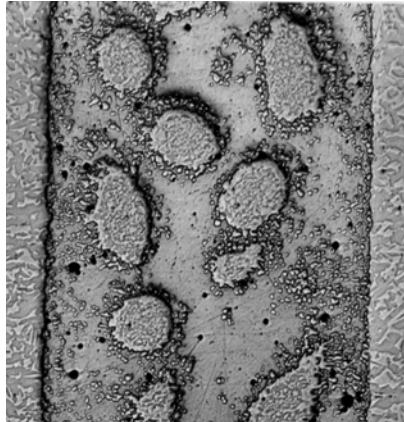
Рисунок 3.6 – Мікроструктура (x20) металу шва при просоченні латунню наповнювача із суміші 1:1:1 дискретних волокон зі сталей 20, 65Г і копелю МНМЦ43-0,5
