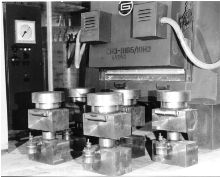
Рисунок 4.10 - Заготовки сталевих циліндрів компресорів, що зібрані для автовакуумного паяння
