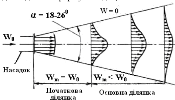
Рисунок 19 – Розподіл швидкостей уздовж осі вільного струменя
