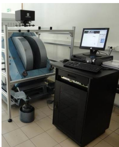
Рис. 2.7. Зовнішній вигляд вібраційного магнітометра VSM Lake Shore лабораторії Університету Лотарингії (м. Нансі, Франція)
