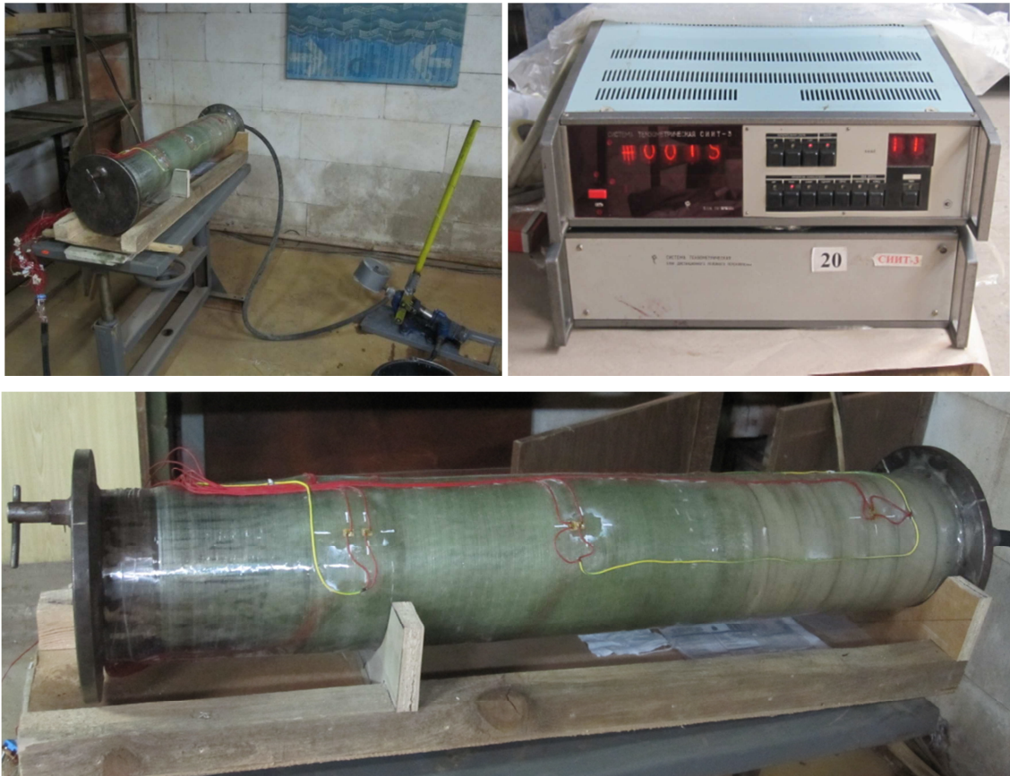
Рисунок 4.7 – Загальний вигляд експериментальної установки для проведення гідростатичних випробувань труби з бандажем
