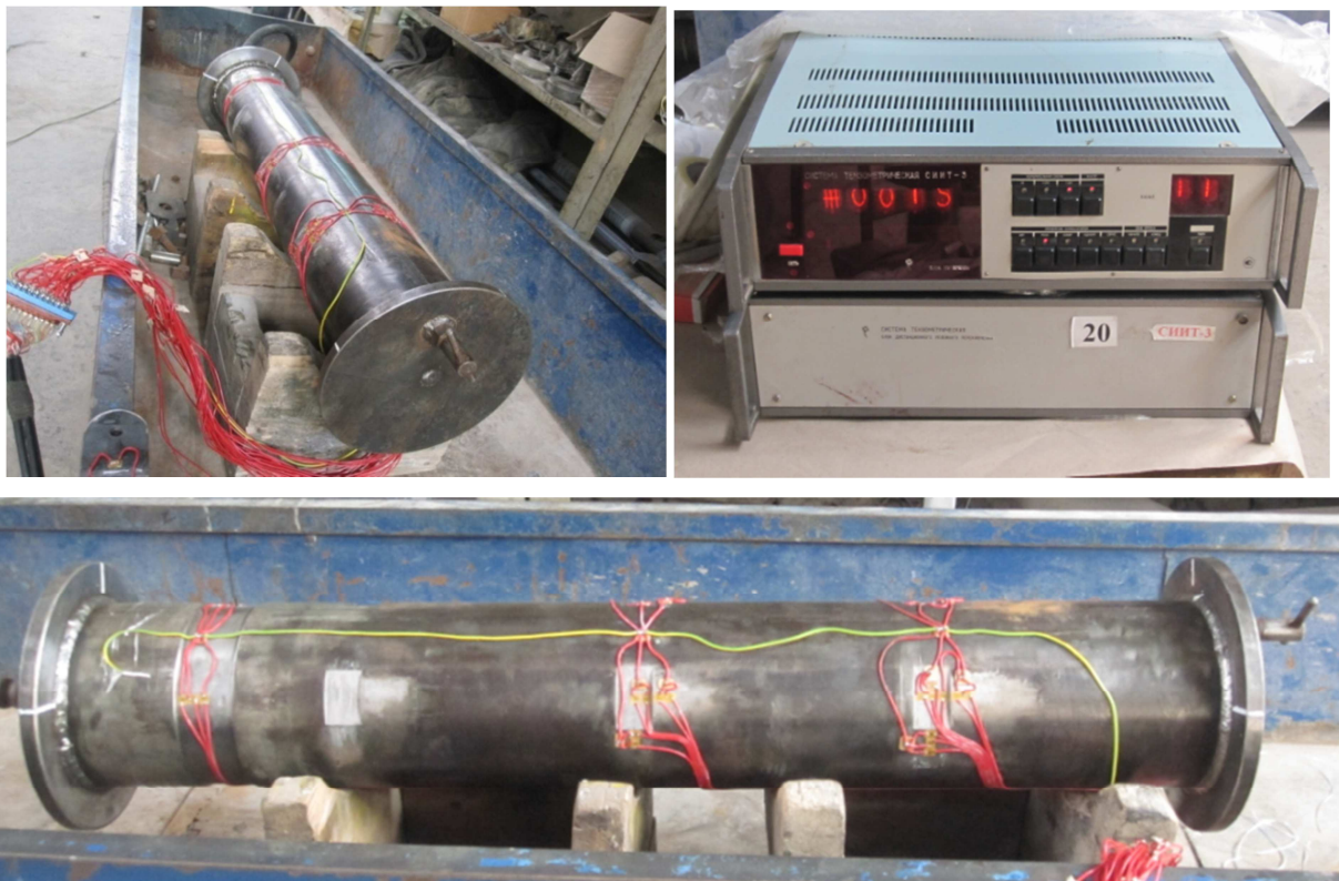
Рисунок 4.6 – Загальний вигляд експериментальної установки для проведення гідростатичних випробувань
