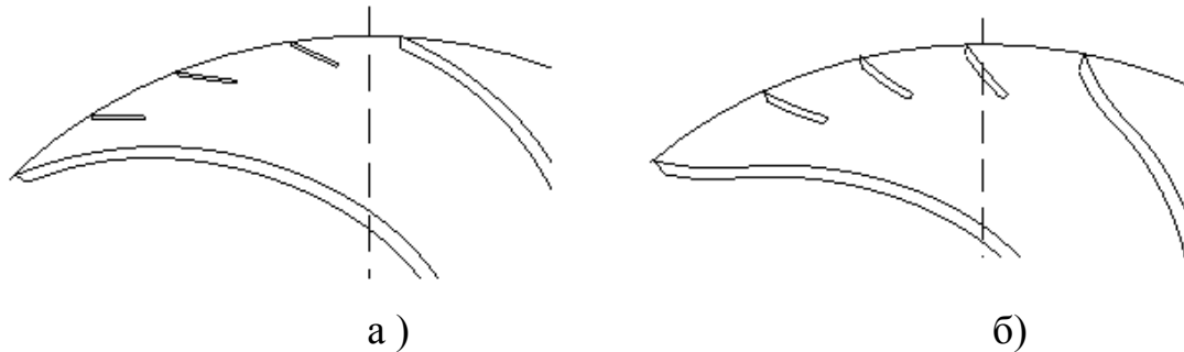
Рисунок 11 – Схеми лопатевих ґраток, запропоновані для оптимізаційного аналізу
