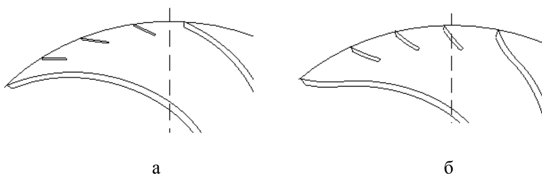
Рисунок 4.1 – Схемы лопастных решеток, предложенные для оптимизационного анализа
