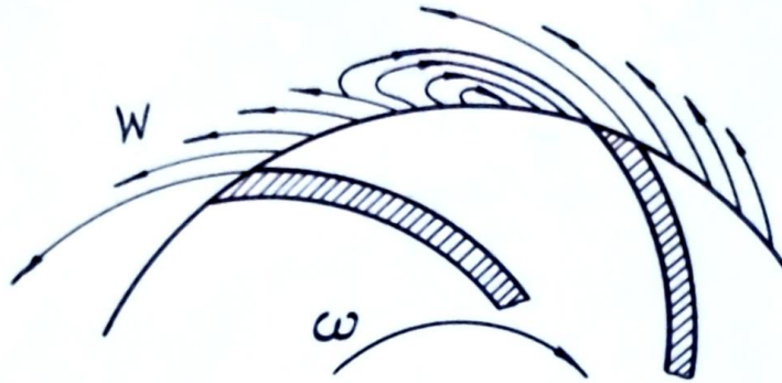
Рисунок 1.2 – Схема потока на выходе из РК
