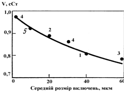
Рисунок 1.7 – Вплив середнього розміру неметалічних включень на в'язкість сталі ШХ15 при 1600 °С (цифри у точках – число досліджених зразків)
