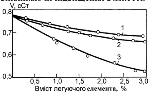
Рисунок 1.5 – Вплив кремнію (1), хрому (2) і марганцю (3) – а і фосфору (4), миш'яку (5) та сірки (6) – б на кінематичну в'язкість рідкого заліза при 1600 °C
