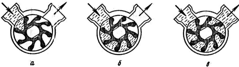
Рисунок 7.8 – Насос типу Jabsco (схема робочого циклу): а – початкова фаза (всмоктування); б – проміжна фаза; в – кінцева фаза (нагнітання)
