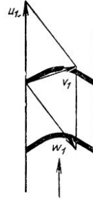
Рисунок 1.7 – Насос із перерізом каналу прямокутної форми Рисунок 1.8 – Переріз лопатей «кутом уперед»
