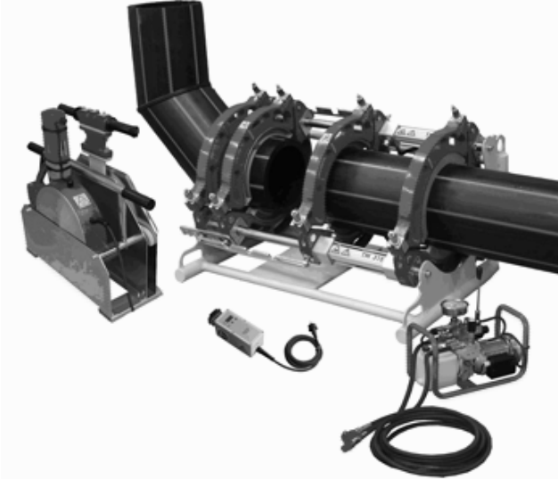
Рисунок 2.9 – Зварювання труб за допомогою центратора
