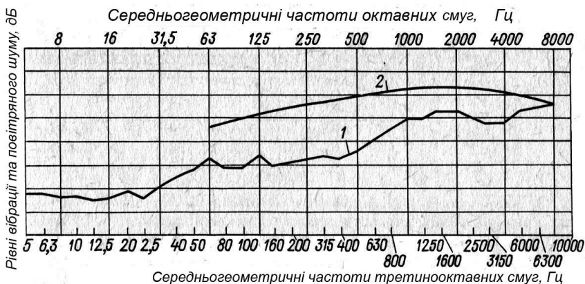
Рисунок 1.5 – Віброшумова характеристика лопатевого насоса: 1 – спектр вібрації; 2 – спектр шуму
