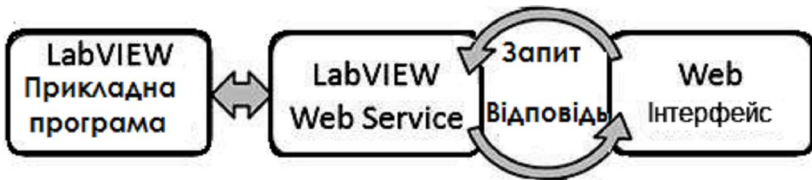
Рисунок 1 – Структура взаємодії віртуального приладу LabVIEW через web service в мережі Інтернет
