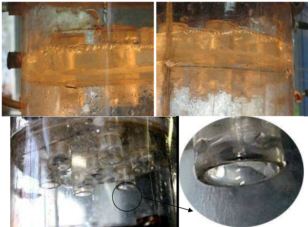
Рисунок 20 – Фотографії оптимального гідродинамічного режиму 4. Режим унесення (рисунок 21), при якому об'єм рідини, яка поступає в центральну частину масообмінного елемента з полотна тарілки через трубку диспергується у меншій мірі, ніж при оптимальному режимі, оскільки газ проходить через шар рідини у вигляді цівок.
