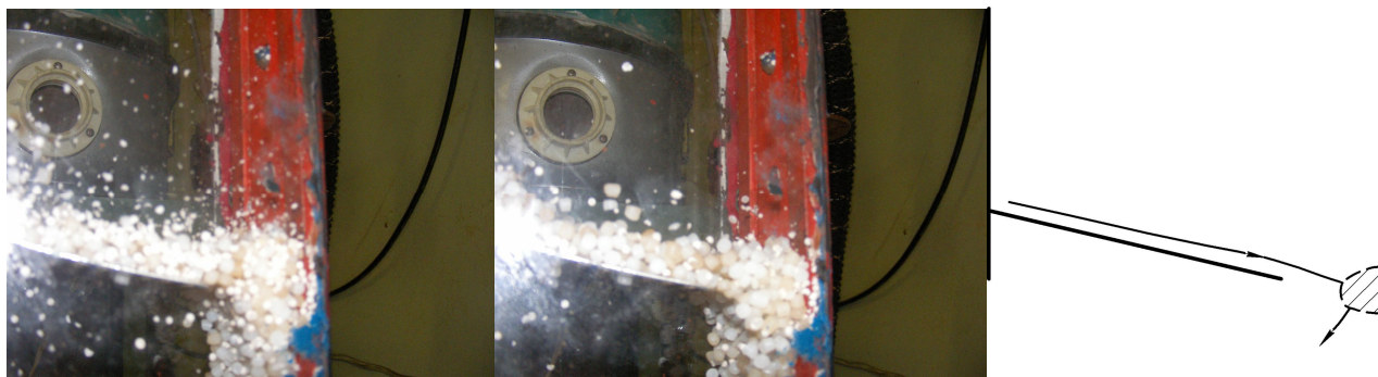
Рисунок 4.4 – Робота сушарки у режимі гравітаційного падаючого шару дисперсного матеріалу
