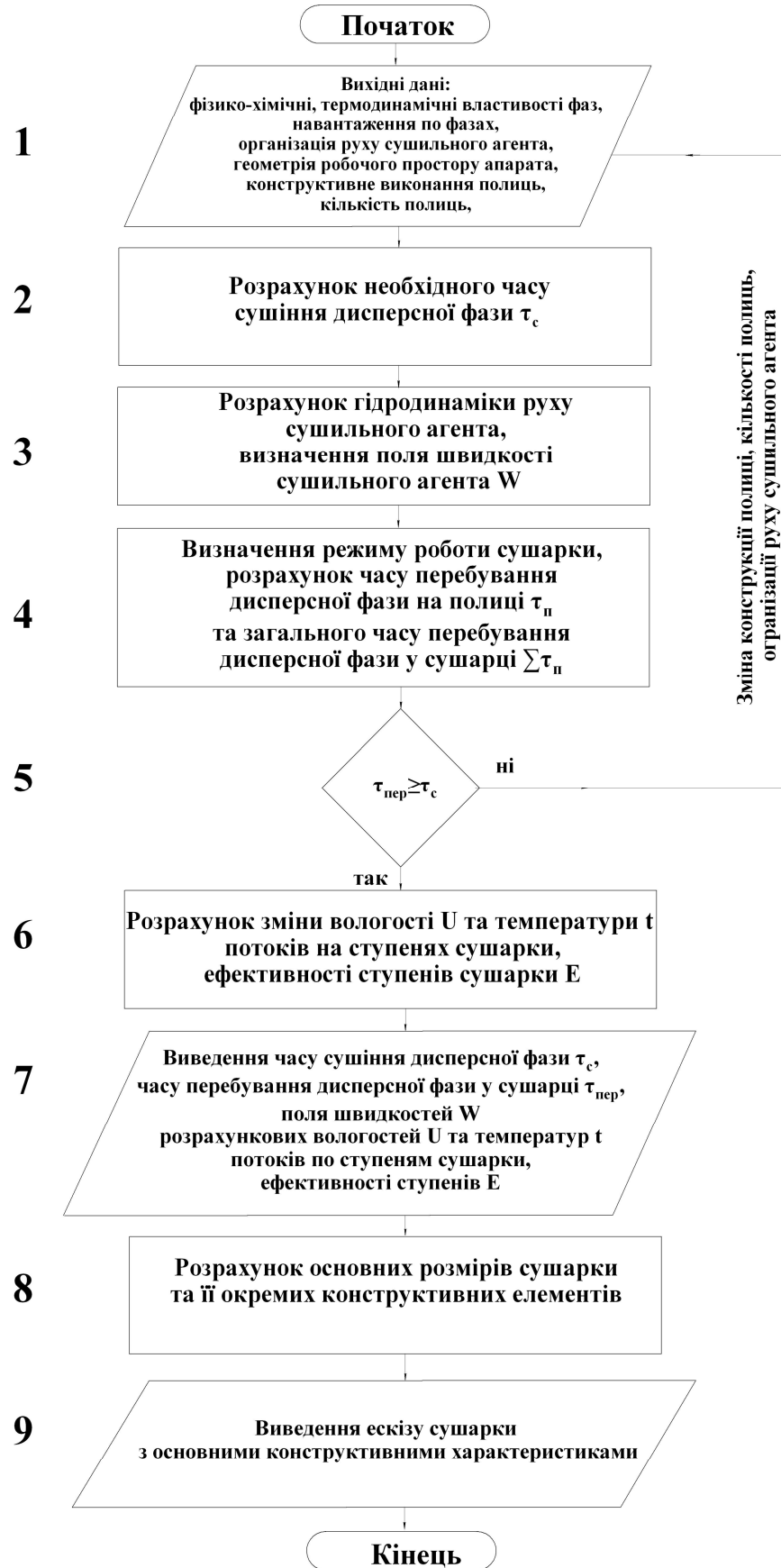
Рис. Б.1 – Блок-схема інженерного розрахунку гравітаційних поличних сушарок з вертикальним секціонуванням робочого простору.
