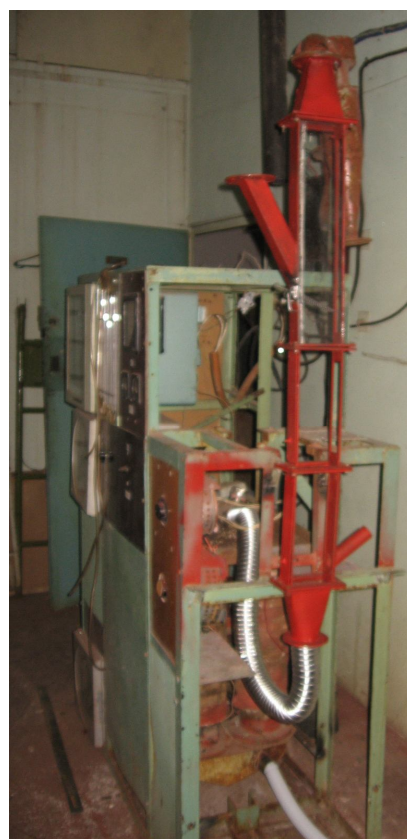
Рисунок 2.2 – Експериментальна установка для дослідження гідродинаміки та кінетики процесу сушіння в гравітаційних поличних апаратах: а – модель установки та монтажне креслення; б – фото установки
