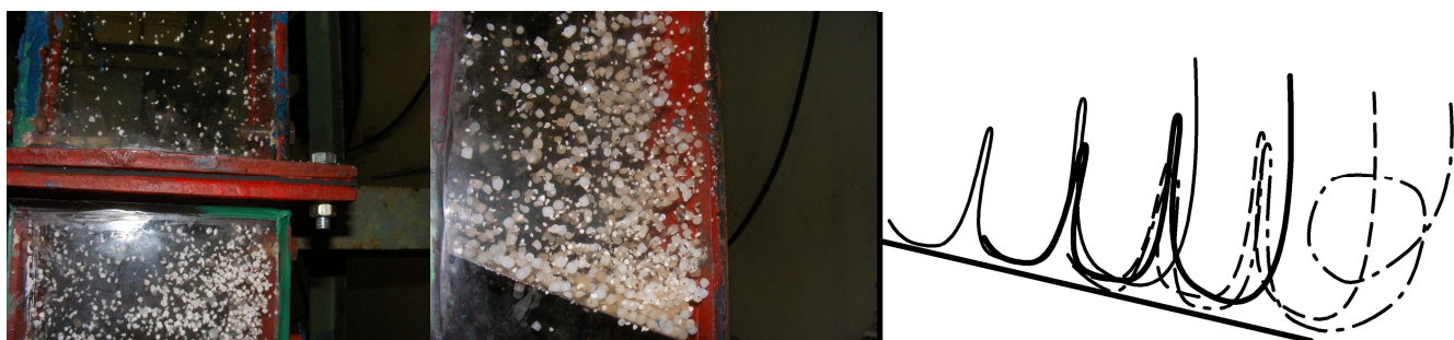
Рисунок 4.9 – Робота сушарки у режимі винесення дисперсного матеріалу
