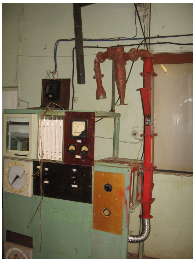
Рисунок 2.2 – Експериментальна установка для дослідження гідродинаміки та кінетики процесу сушіння в гравітаційних поличних апаратах: а – модель установки та монтажне креслення; б – фото установки
