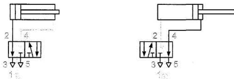
Рисунок 4.6 – Управление пневмоцилиндром двустороннего действия 5/2-пневмораспределителем
