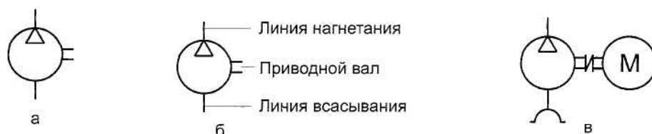
Рисунок 2.11 – Условное графическое обозначение компрессора:
