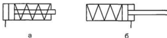
Рисунок 3.3 – Условные графические обозначения пневмоцилиндров одностороннего действия:
