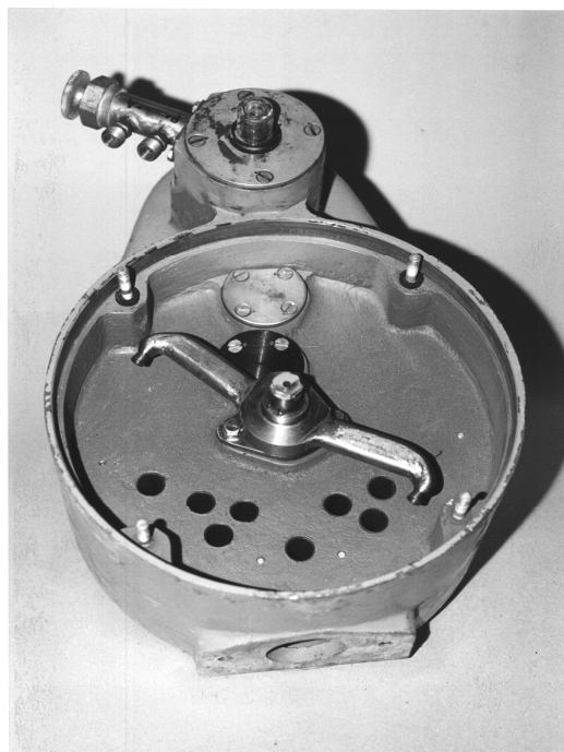
Рисунок 3.30 – Струйно-реактивный пневмодвигатель (пневмомотор со струйно-реактивной турбиной)
