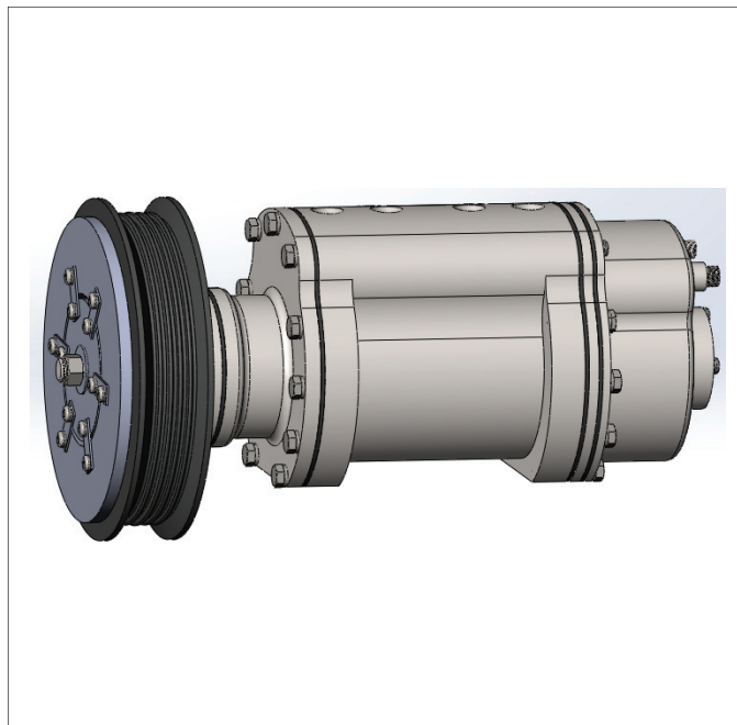
Рис. 1. Роторный компрессор с катящимся ротором транспортной холодильной установки
