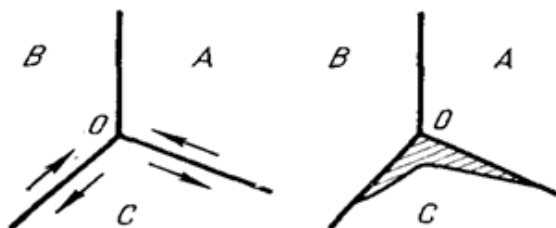
Рисунок 7.9 – Схема зародження тріщини на стику трьох зерен за рахунок міжзернових зміщень: а – до початку зміщення (стрілками показані напрями зміщення); б – після утворення тріщини
