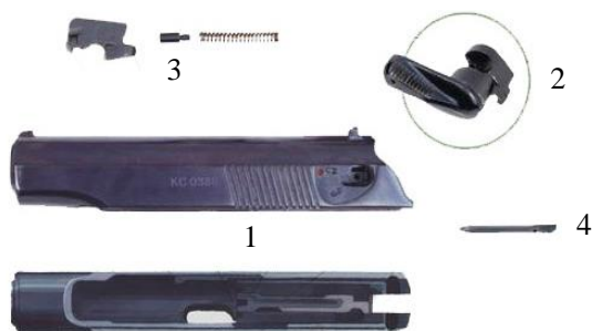
Рисунок 10.5 – Затвор: 1 – загальний вигляд затвора; 2 – запобіжник; 3 – викидач; 4 – ударник
