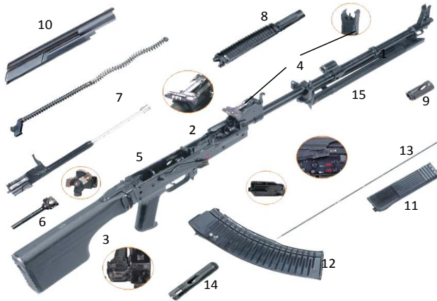
Рисунок 10.3 – Основні частини і механізми кулемета РПК-74М:
