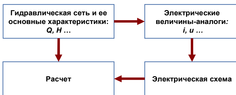
Рисунок 3 - Принцип электрогидравлического моделирования
