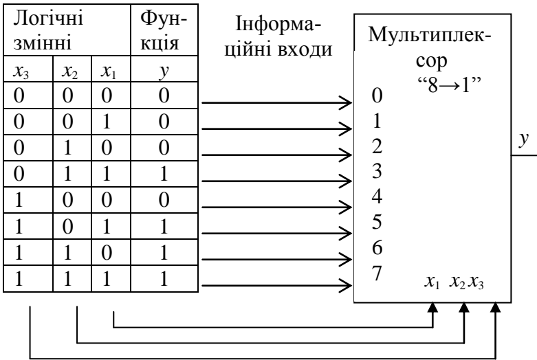
Рисунок 5.16 – Реалізація логічної функції (5.1) за допомогою мультиплексора
