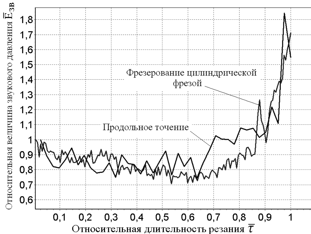
Рисунок 2.30 – Изменение тренда относительной величины звукового давления в зависимости от длительности резания
