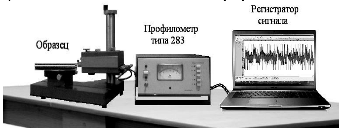
Рисунок 4.6 – Регистрация параметра шероховатости R_a посредством профилометра типа 283 и ноутбука
