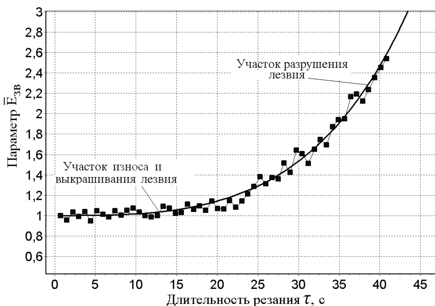
Рисунок В.2 – Аппроксимация графиком модели (3.13) экспериментальных данных о характере изменения параметра \bar{E}_{зв} звука, сопровождающего процесс фрезерования при износе, выкрашивании и последующем сколе зуба цилиндрической фрезы
