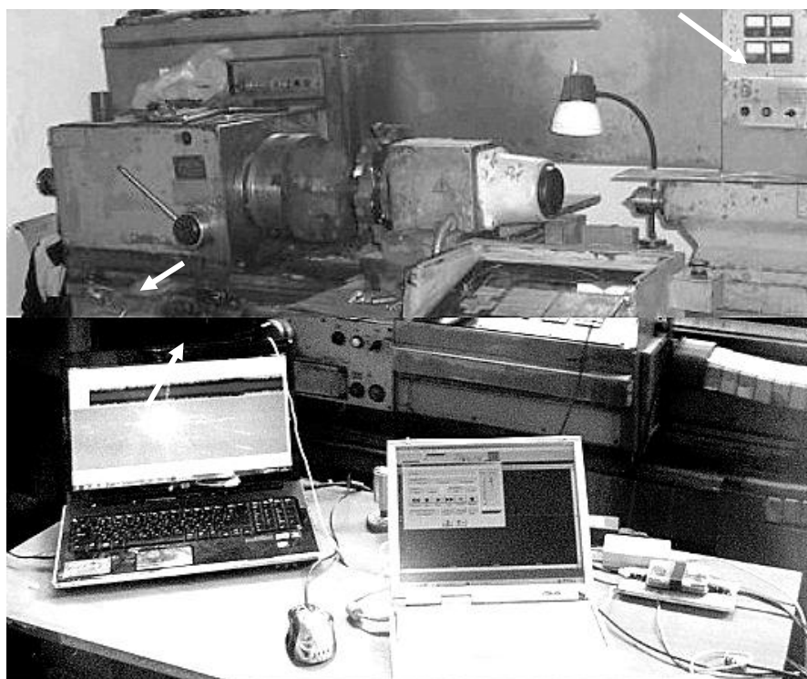
Рисунок 5.1 – Регистрация звукового и вибрационного сигналов в эксперименте
