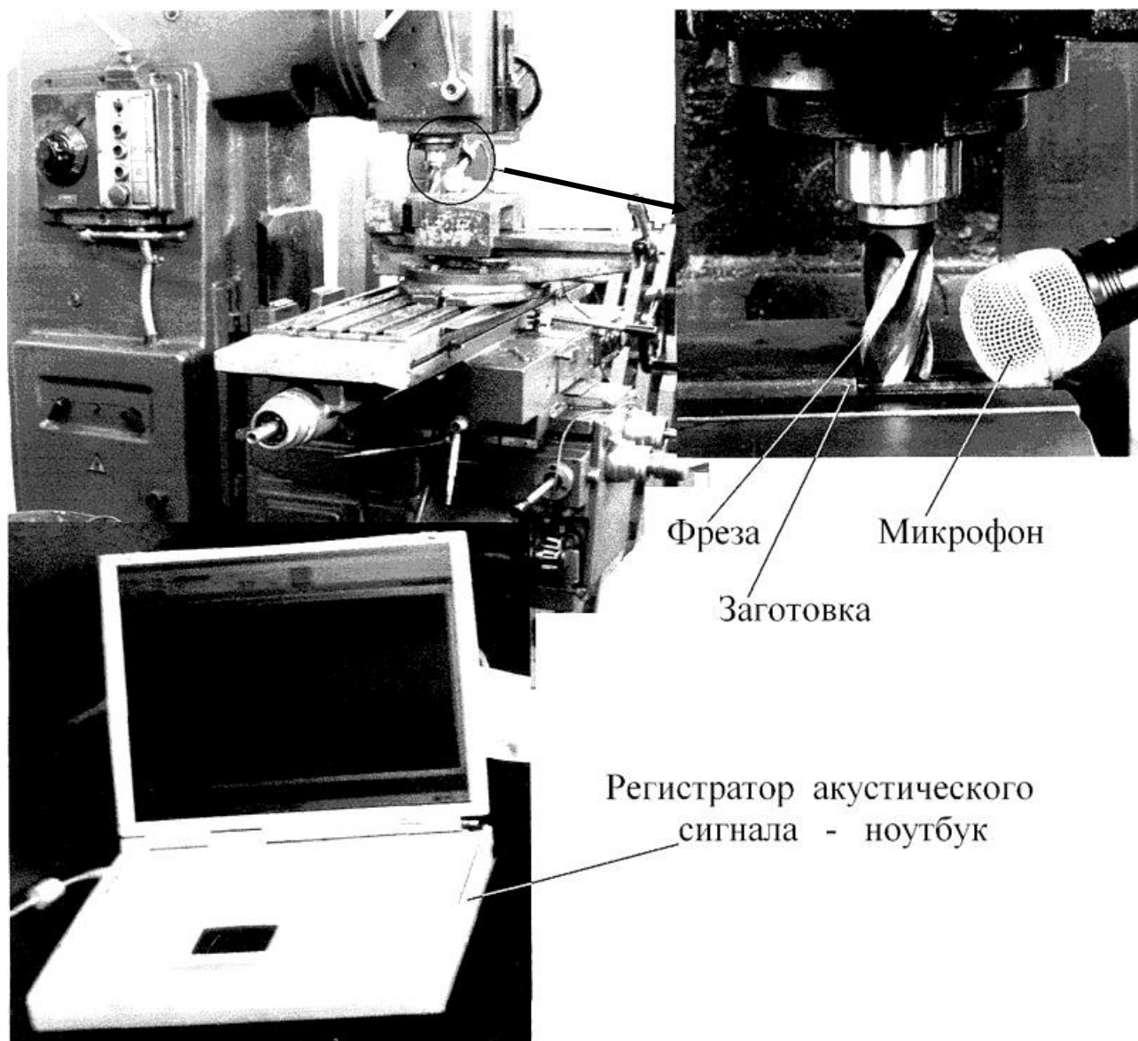
Рисунок 5.3 – Общий вид экспериментальной установки обрабатывающей системы фрезерного станка
