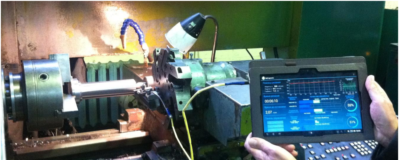
Рисунок 5.8 – Автоматизированный контроль технического состояния обрабатывающей системы токарного станка
