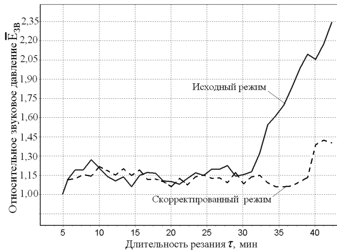
Рисунок 4.12— Характеристики звука: а) временная реализация звука; б) спектр звука; в) тренд параметра \bar{E}_{зв} на исходном и скорректированном режимах резания; г) сравнение требуемого и прогнозируемого ресурса инструмента
