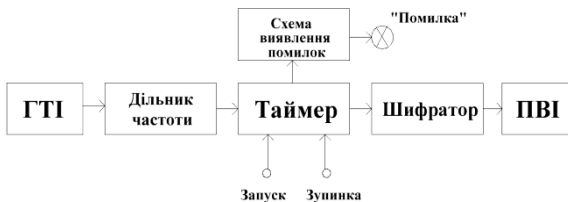
Рисунок 1 – Структурна схема системи виміру часу
