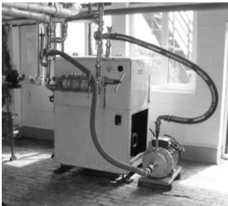
Рисунок 3.12 - Роторно-динамічний та плунжерний гомогенізатори в умовах ТОВ «Добряна»
