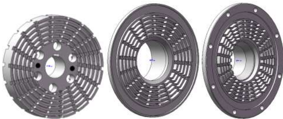
Рисунок 3.9 – Робоче колесо, передній та задній статори
