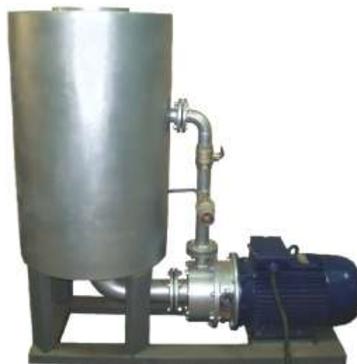
Рисунок 2.9 – Багатофункціональний теплогенеруючий агрегат-гомогенізатор
