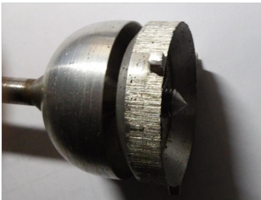
Рисунок 2.45 –Струйный диод дефлекторного типа (патент №68287)
