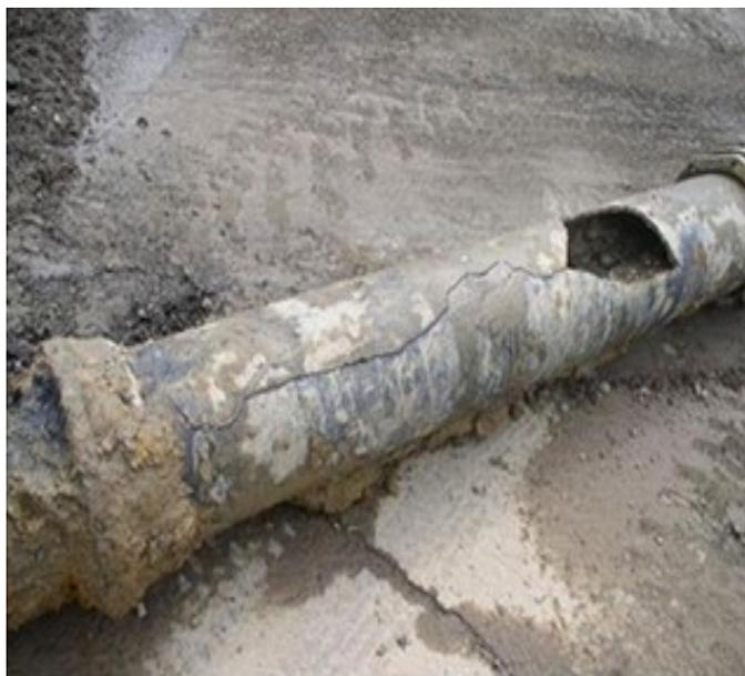
Рисунок 1.4 – Поломка чугунной трубы из-за гидравлического удара[22]
