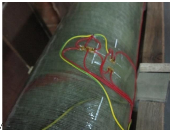
Рисунок 4.17 – Загальний вид розташування тензодатчиків на лицьовій поверхні бандажа
