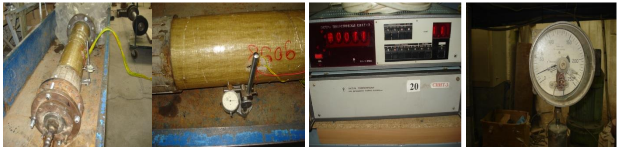
Рисунок 4.4 – Загальний вигляд установки для проведення гідростатичних випробувань
