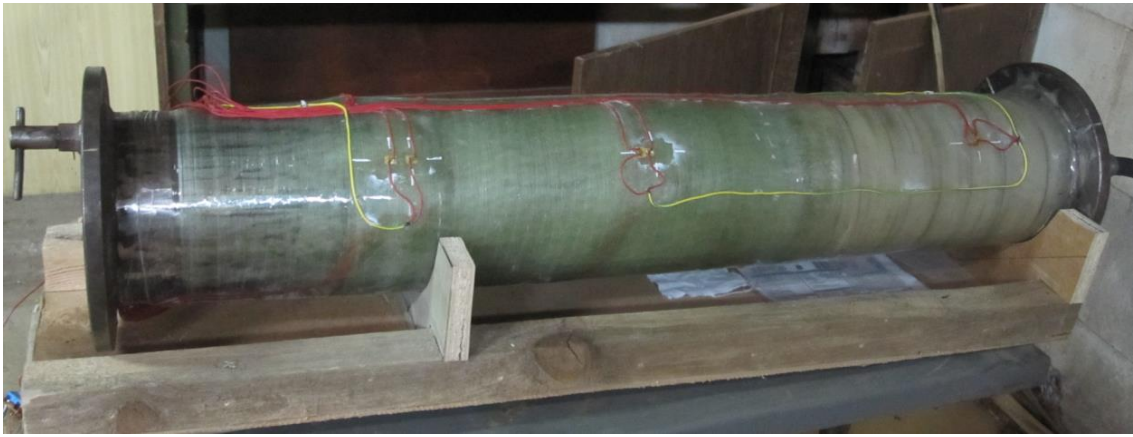
Рисунок 4.7 – Загальний вигляд експериментальної установки для проведення гідростатичних випробувань труби з бандажем
