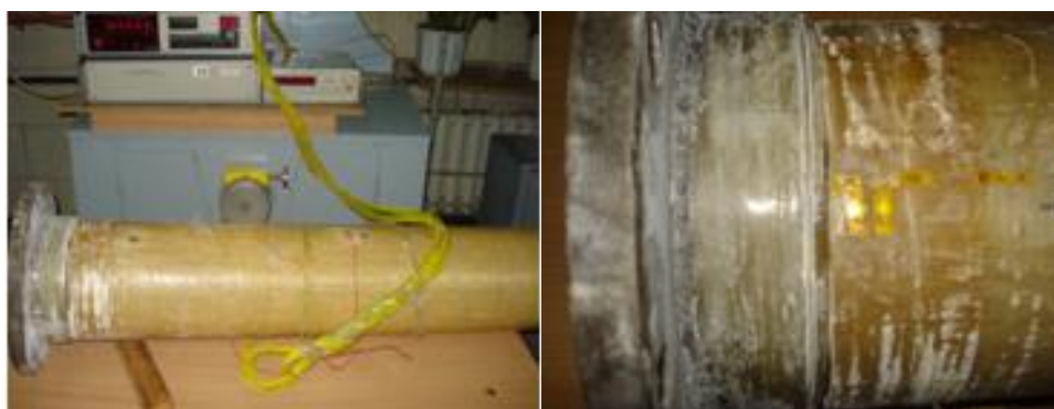
Рисунок 4.15 – Картина руйнування склопластику в зоні фланця
