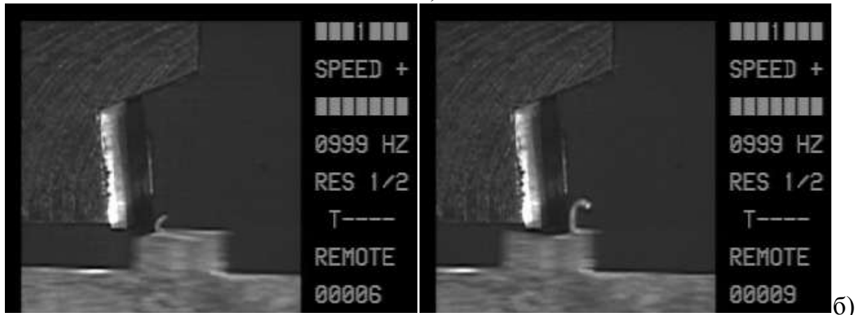
Рисунок 3.7- Схема измерения (а) и примеры фотографий (б), полученных высокоскоростной камерой „Speedcam-Lite“ при обработке стали 45 со скоростью v=100 м/мин и толщиной среза a=0,3 мм
