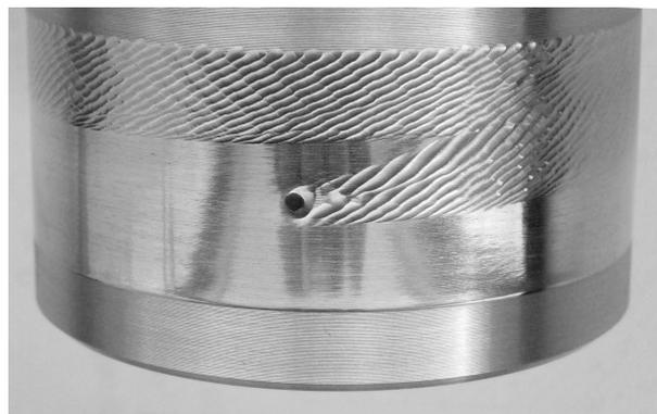
Рис. 4.22. Образец после наноструктурирующего выглаживания [30, 282]. Внизу слева просверлено углубление.
