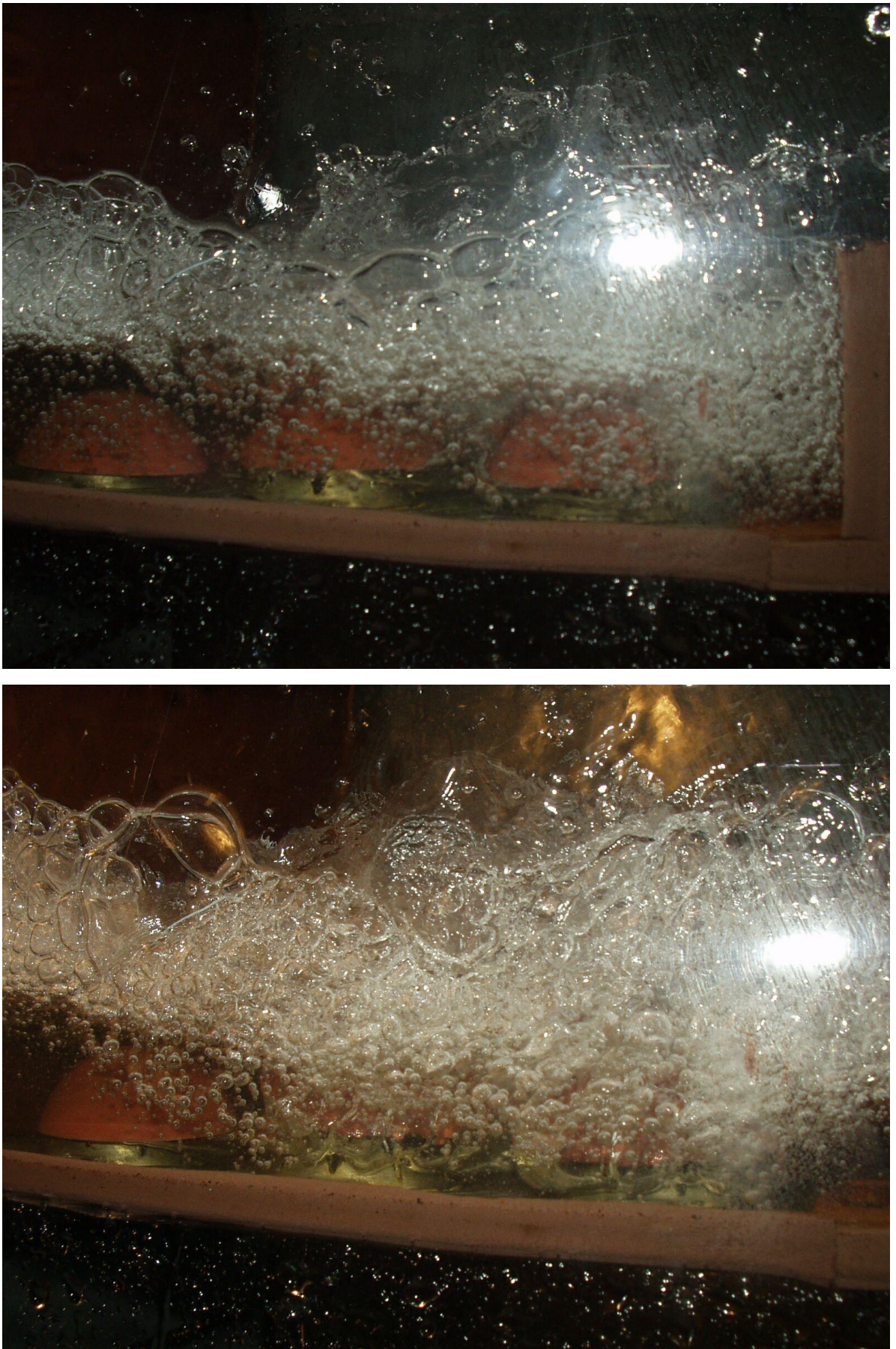
Рис. 3.6. Струминно-інжекційний режим роботи тарілки
