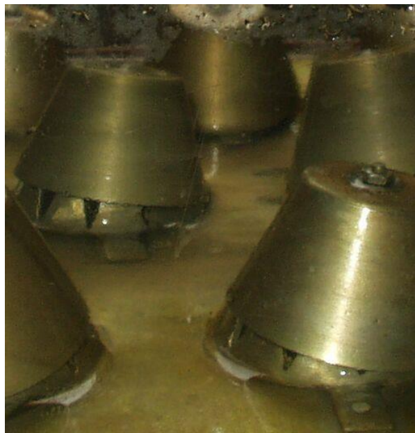
Рис. 2.4. Клапанна тарілка з конічними клапанами [25]
