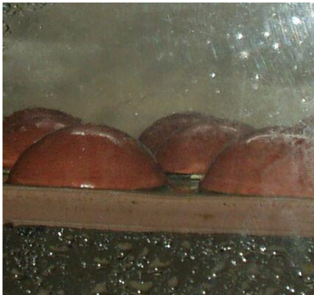
Рис. 2.6. Клапанна тарілка зі сферичними клапанами [35]
