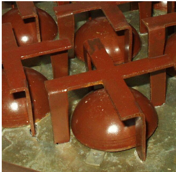
Рис. 2.5. Клапанна тарілка зі сферичними клапанами [26]
