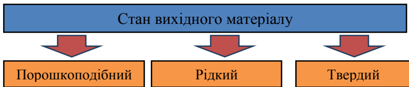
Рисунок 5.5 – Вихідні стани використовуваних матеріалів технологій RP
