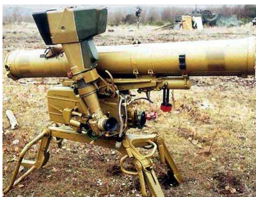
Рисунок 1.7 – Протитанковий ракетний комплекс 9К111 «Фагот» (ПУ з ракетою 9М111М «Факторія» у транспортно-пусковому контейнері)
