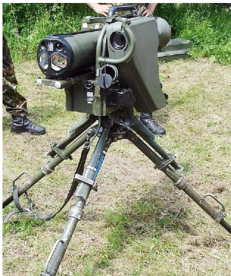
Рисунок 1.17 – Протитанковий ракетний комплекс «MILAN» бундесверу, обладнаний системою ADGUS
