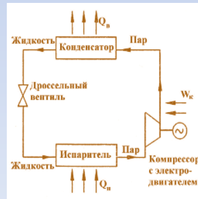
Схема парокompресійного теплового насоса: 1 - конденсатор; 2 - дросель; 3 - випарник; 4 - компресор
