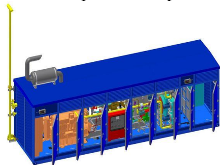
Рисунок 3.53 – Загальний вигляд газової КС із газопоршневим приводом
