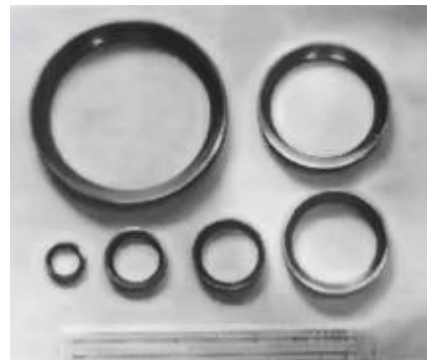
Рисунок 2.34 – Ущільнювальні кільця \varnothing 25–200 мм кульових кранів у стані після плакування (а) та механічного оброблення (б)
