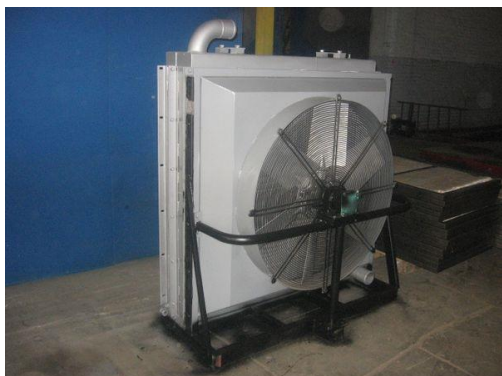
Рисунок 5.49 – Охолоджувач антифризу бурового верстата СБШ-160/200-40Д із дизельним приводом
