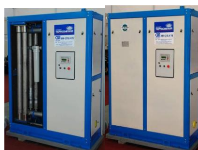
Рисунок 5.35 – Установка одержання азоту (харчова промисловість, Україна, Запорізька обл.)
