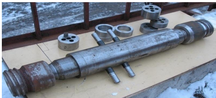
Рисунок 3.83 – Лабораторно-експериментально-промисловий зразок піногенеруючого пристрою ПГП-100х25-5
