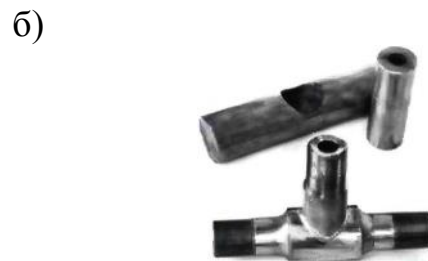
Рисунок 2.19 – Трійники та кути високого тиску зі сталевих штампувань (а) і прокату (б) з нерознімним з'єднанням просоченням наповнювача в широкому зазорі
