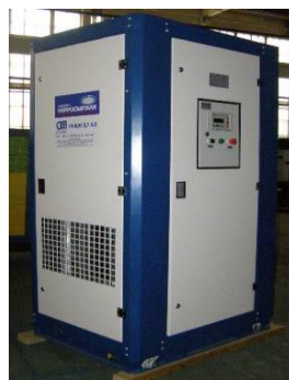
Рисунок 5.43 – Установка одержання азоту (коксохімія, Донецька обл.)
