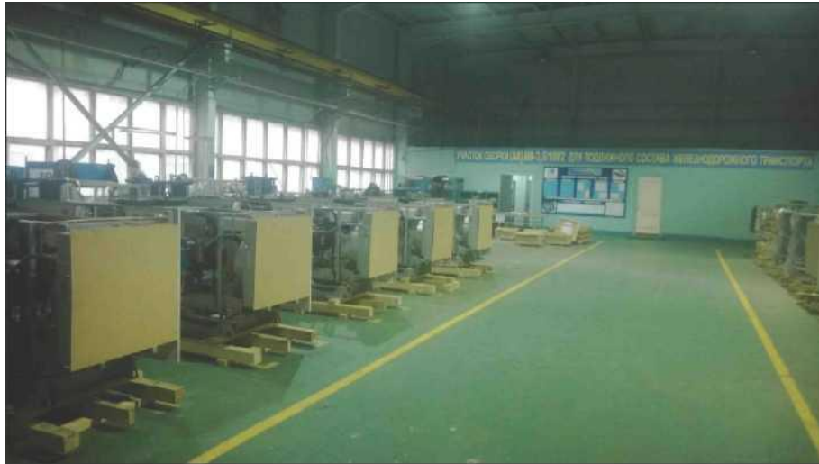
Рисунок 5.68 – Дільниця складання гвинтових гальмових компресорних агрегатів на АТ «НВАТ «ВНДІкомпресормаш»
