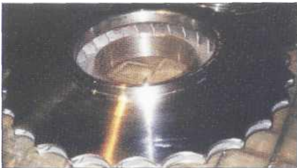
Рисунок 2.89 – Робоче колесо з «ромашкою» на дисках
