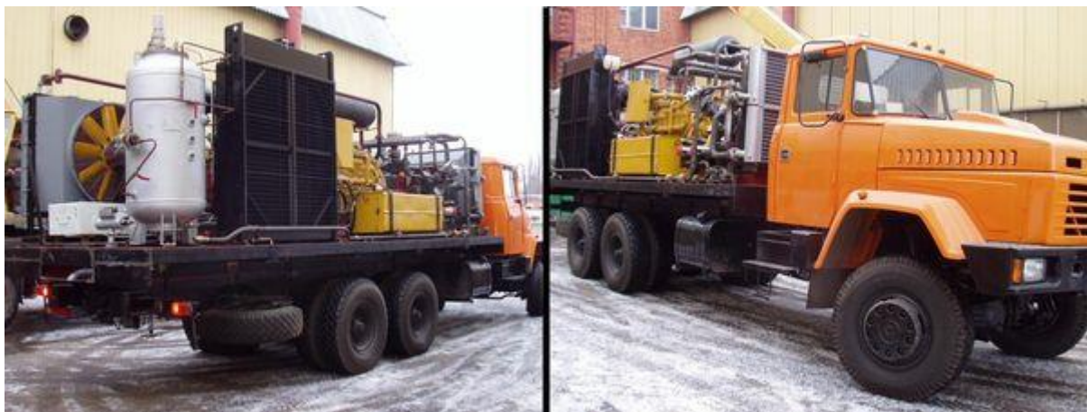
Рисунок 5.48 – Пересувна компресорна установка НД-20/120 зі знятим кузовом
