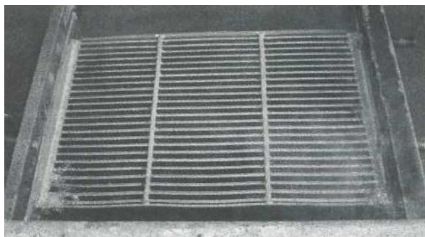
Рисунок 2.66 – Випробування на герметичність паяного ПРЕ
