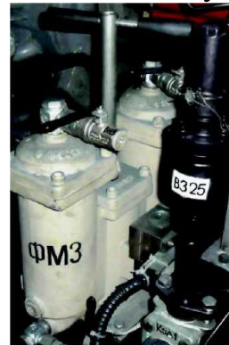
Рисунок 3.33 – Здвоєний масляний фільтр надтонкого очищення
