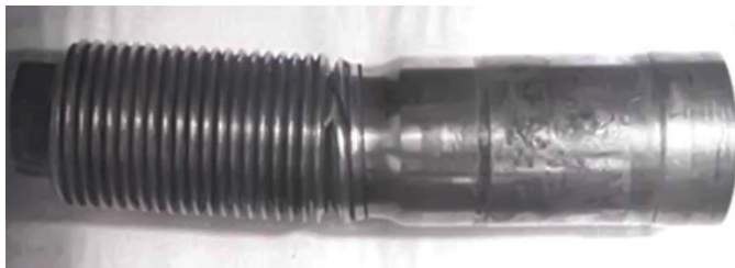
Рисунок 2.1 – Загальний вигляд руйнування нарізної частини штока поршня
