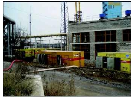
Рисунок 4.11 – Робота дивізіону азотних пересувних станцій під час гасіння пожежі на шахті ім. О. Ф. Засядька
