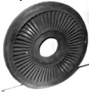
Рисунок 2.28 – Півмуфта відцентрового насоса з тавровими з'єднаннями з композиційного металу
