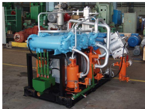
Рисунок 5.50 – Система охолодження компресора для стиснення харчової вуглекислоти
