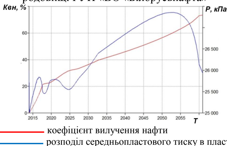
Рисунок 3.89 – Зміна коефіцієнта вилучення нафти і розподіл середньопластового тиску в пласті при термогазовому впливі
