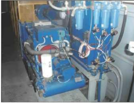
Рисунок 5.62 – Компресорний агрегат ВВ-3,5/10 для електровоза
