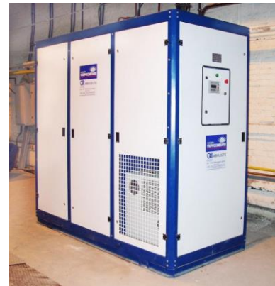
Рисунок 5.41 – Азотна станція переносна (машинобудування, Білорусь)
