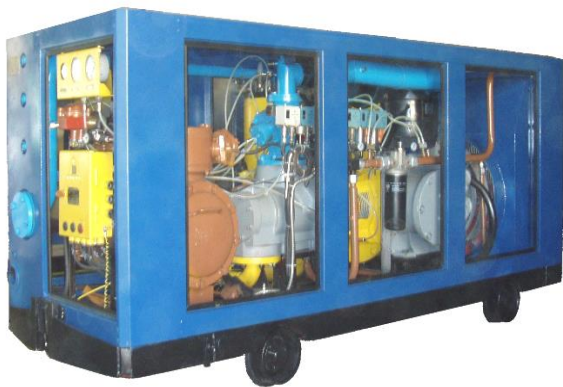
Рисунок 3.119 – Шахтна гвинтова компресорна установка УКГШ-10/7 А У2 з електричною системою захисту
