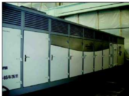
Рисунок 3.46 – Зовнішній вигляд блокової дотискної компресорної станції СГВ 4-00-65/4-26 У1
