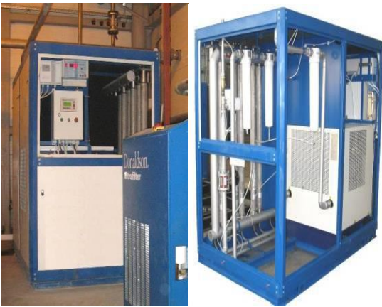
Рисунок 5.36 – Установка одержання азоту (харчова промисловість, Україна, м. Запоріжжя)
