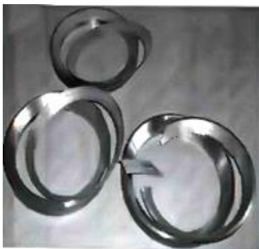
Рисунок 2.30 – Ущільнювальні кільця кульового крана з відшарованим покриттям, нанесеним плазмовим напиленням
