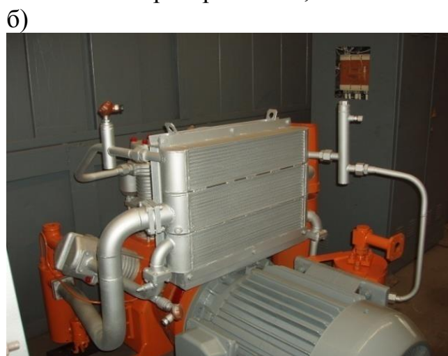
Рисунок 2.78 – Блок міжступеневих повітроохолоджувачів КУ ЗВШ1, 6-3/46 старої (а) і нової (б) конструкції
