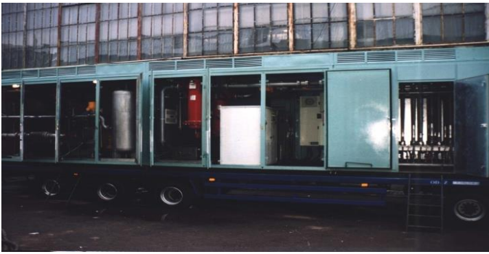
Рисунок 4.10 – Конструктивне виконання станції АМГП-15/0,7 С У1
