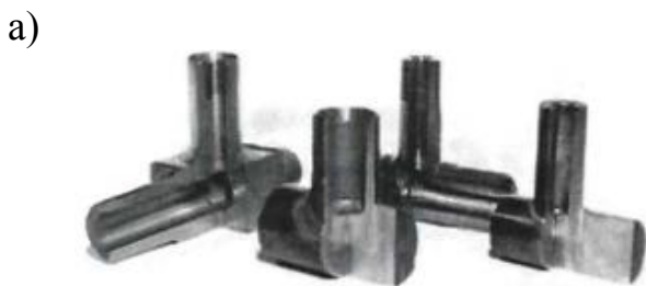
Рисунок 2.19 – Трійники та кути високого тиску зі сталевих штампувань (а) і прокату (б) з нерознімним з'єднанням просоченням наповнювача в широкому зазорі
