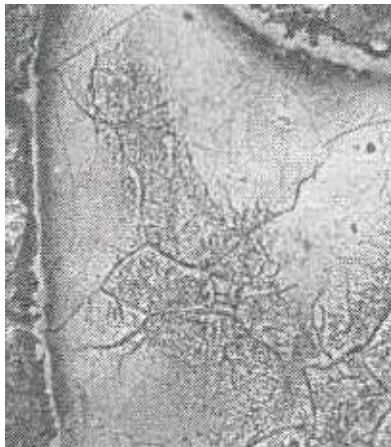
Рисунок 2.10 – Мікроструктура (x200) композиційного металу, сформованого просоченням наповнювача із суміші нікеля і низьковуглецевої сталі сплавом Cu-Mn
