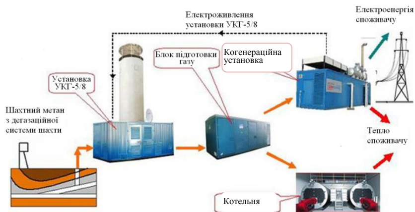
Рисунок 6.1 – Схема енергетичного використання установки УКГ-5/8
