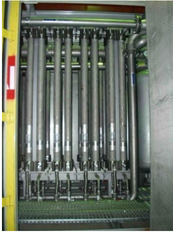
Рисунок 4.8 – Мембранний модуль станції АМГП-15/0,7 С У1
