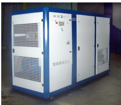
Рисунок 5.42 – Переносна азотна станція (металургія, Луганська обл.)
