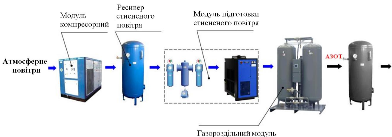
Рисунок 5.19 – Схема одержання газоподібного азоту
