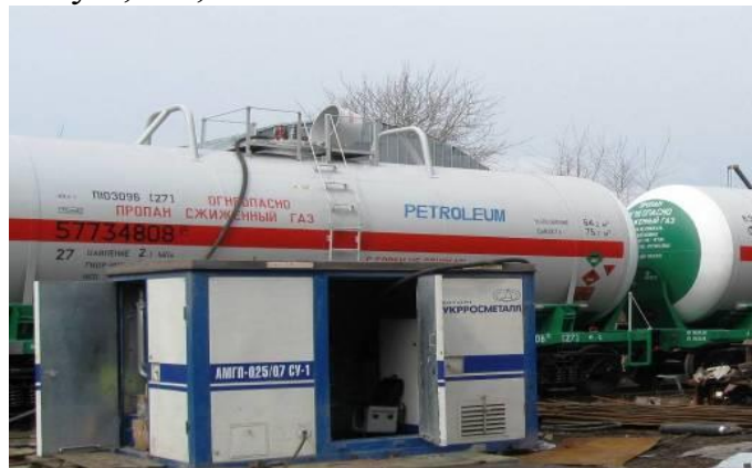
Рисунок 5.47 – Азотна переносна станція АМГП-0,25/0,7 С В1 (ВАТ «Полтавахіммаш», м. Полтава)
