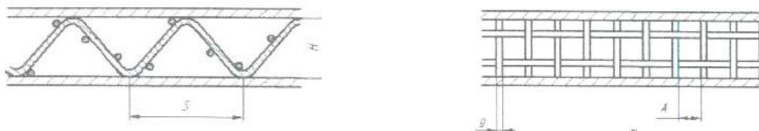
Рисунок 2.53 – Схема перерізу масляного каналу із сітковою насадкою при розміщенні гофр уздовж (а) і поперек (б) потоку масла
