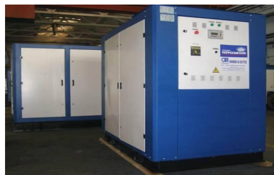
Рисунок 5.44 – Станція азотна (хімічна галузь, Україна, Луганська обл.)
