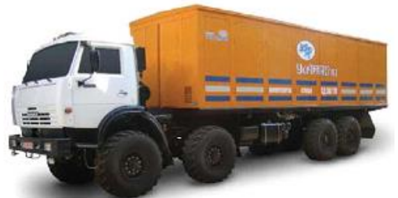
Рисунок 3.93 – Схема та загальний вигляд компресорної станції СД-30/120
