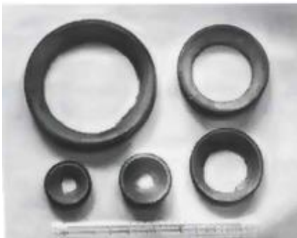
Рисунок 2.34 – Ущільнювальні кільця \varnothing 25–200 мм кульових кранів у стані після плакування (а) та механічного оброблення (б)
