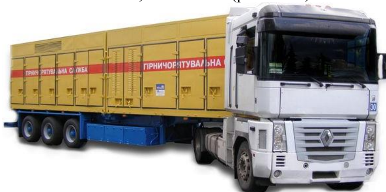
Рисунок 3.95 – Станція азотна мембранна гвинтова пересувна
