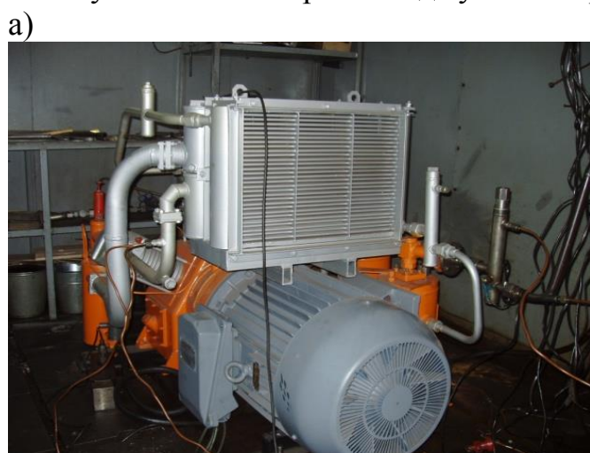
Рисунок 2.78 – Блок міжступеневих повітроохолоджувачів КУ ЗВШ1, 6-3/46 старої (а) і нової (б) конструкції
