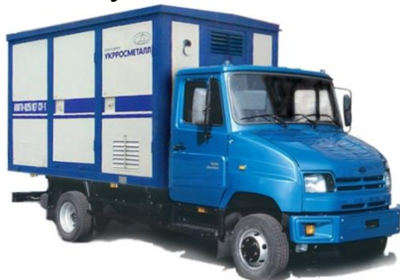
Рисунок 3.96 – Станція азотна мембранна гвинтова пересувна
