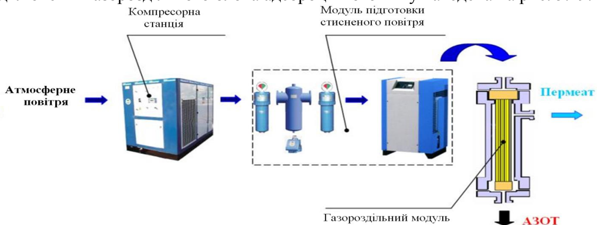
Рисунок 5.18 – Схема організації системи виробництва стисненого повітря
