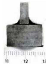
Рисунок 2.25 – Схема формування таврового з'єднання з композиційного металу (а) і макрошліф з'єднання (б): 1 – розміщення металу матриці перед просоченням; 2 – жолобник із наповнювача перед просоченням
