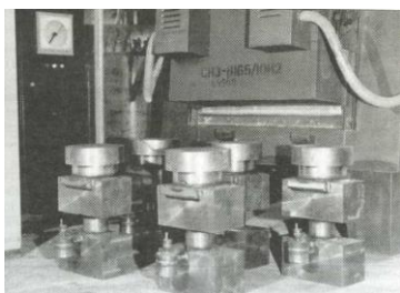
Рисунок 2.81 – Заготовки сталевих циліндрів компресорів, складених для автовакуумного паяння, (а) та схема складання деталей для автовакуумного паяння при широкому паяльному зазорі (б)
