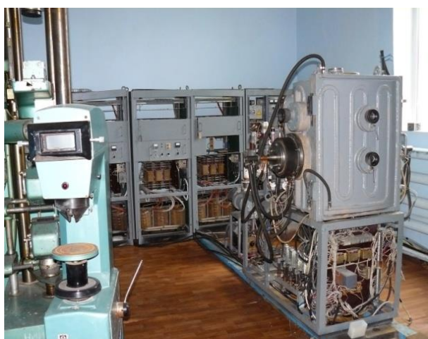
Рисунок 2.37 – Зовнішній вигляд установки для нанесення захисних покриттів на деталі компресорних машин
