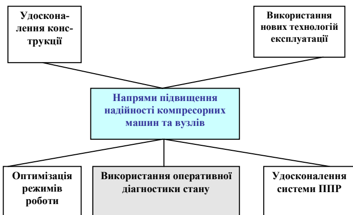
Рисунок 3.123 – Напрями підвищення надійності компресорних машин
