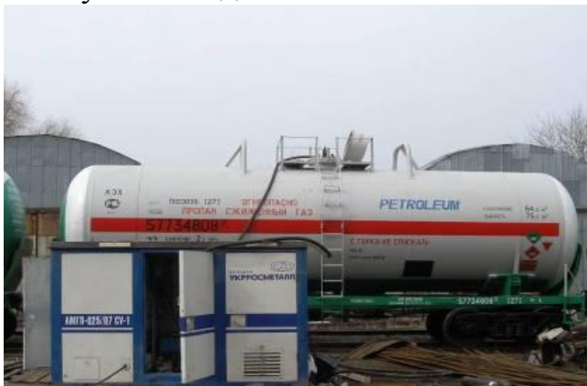
Рисунок 5.47 – Азотна переносна станція АМГП-0,25/0,7 С В1 (ВАТ «Полтавахіммаш», м. Полтава)
