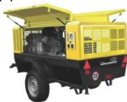
Рисунок 5.57 – Пересувна гвинтова компресорна установка ВВП-6/7, продуктивність 6 м 3 /хв, тиск 0,7 МПа
