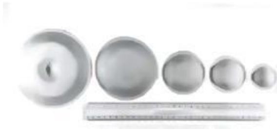
Рисунок 2.33 – Керамічні форми для плакування ущільнювальних кілець 100, 80, 50, 40, 25 мм
