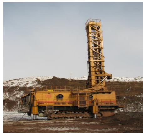
Рисунок 3.121 – Буровий верстат СБШ-250МНА-32КП із компресорною установкою ВВ-50/8У2
