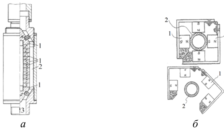
а – патент UA 41691; б – патент JP 2005254155; 1 – магніти (джерело магнітного поля); 2 – труба (зазор) для проходження розчину; 3 – напрямок руху водного розчину
