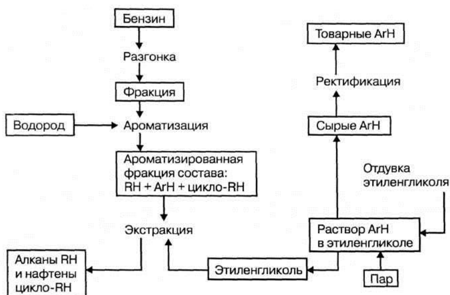
Рисунок 15.7 – Схема платформинга для ароматизации
