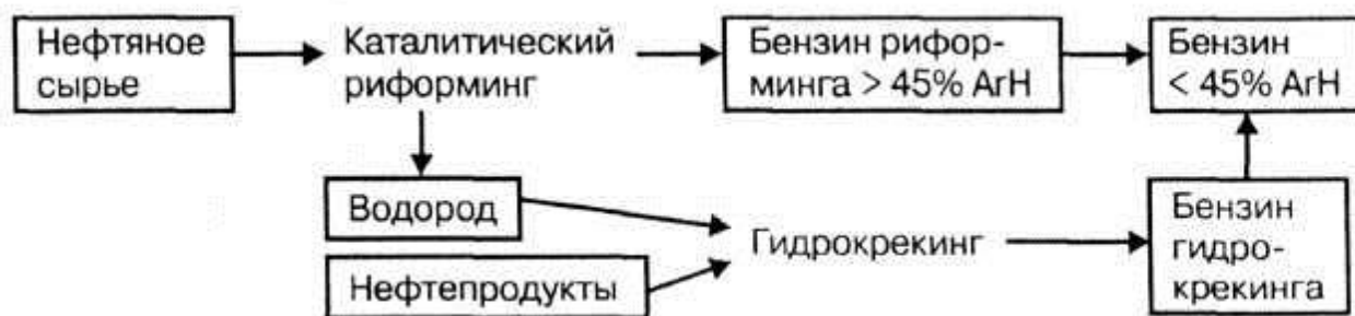
Рисунок 15.4 – Схема корректировки состава бензина
