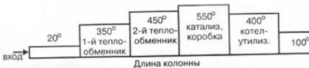
Рисунок 8.13 – График изменения температур в колонне синтеза
