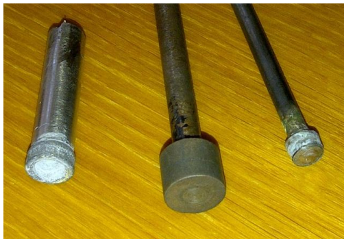
Рисунок 4 – Алмазний інструмент для шліфування сферичної поверхні: кільцевий (зліва), типу АГЦ (в центрі та справа)
