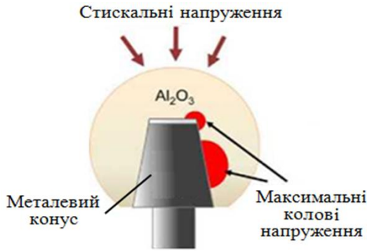
Рисунок 1 – Схематичне зображення протезу стегнової головки з кераміки Al_2O_3 на металевій шийці ніжки штучного суглоба [6]
