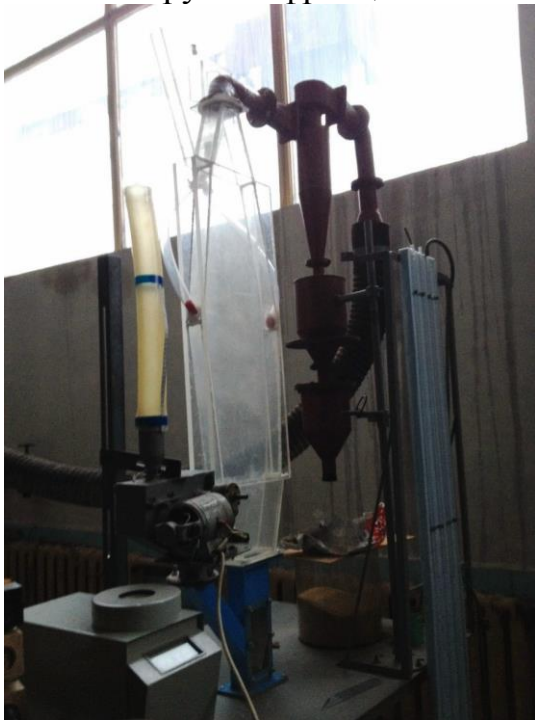
Рисунок 2 – Фото експериментальної установки для дослідження гідродинаміки і ефективності пневмокласифікації
