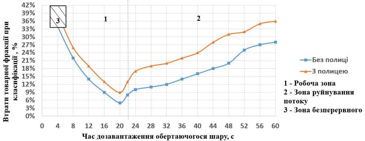
Рисунок 7 – Залежність втрат товарної фракції від часу дозавантаження обертаючого шару матеріалу на прикладі кварцового піску
