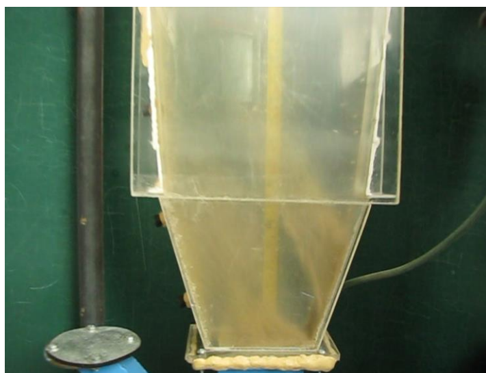
Рисунок 3.4 — Загальний вигляд дозавантаження «подушки» матеріалом
