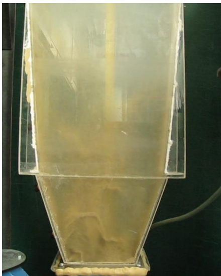
Рисунок 3.2 — Загальний вигляд «подушки», яка створюється в процесі роботи пневмокласифікатора
