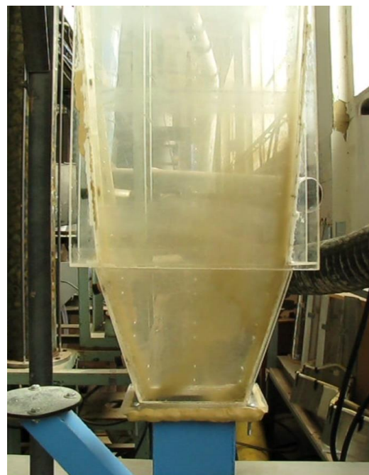
Рисунок 3.5 — Загальний вигляд розвантаженої «подушки» матеріалу
