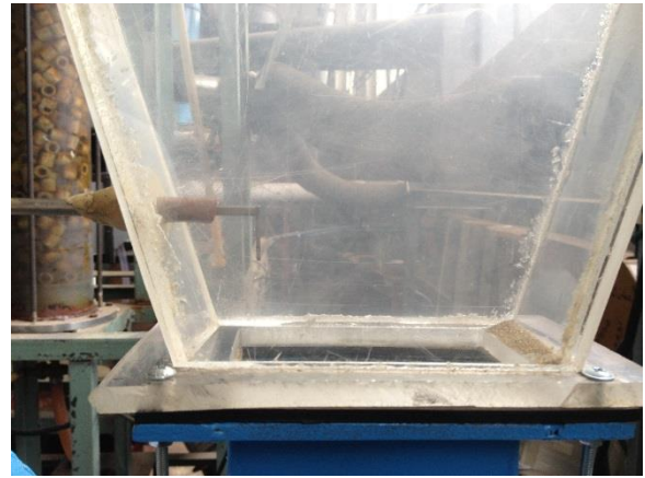
Рисунок 2.4 — Схема замірів тиску в апараті за допомогою трубки Піто-Прандтля.
