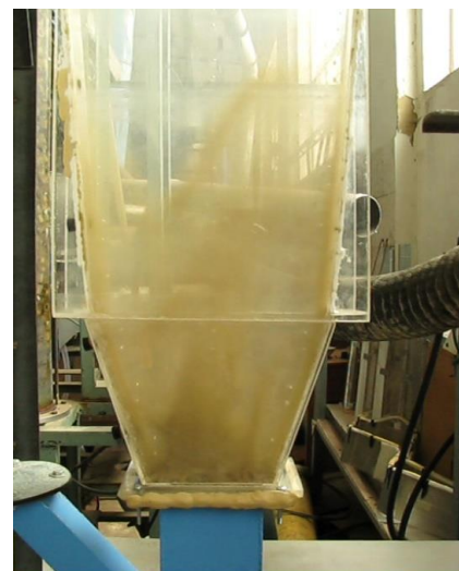
Рисунок 3.3 — Загальний вигляд зміщення центру «подушки» в процесі роботи
