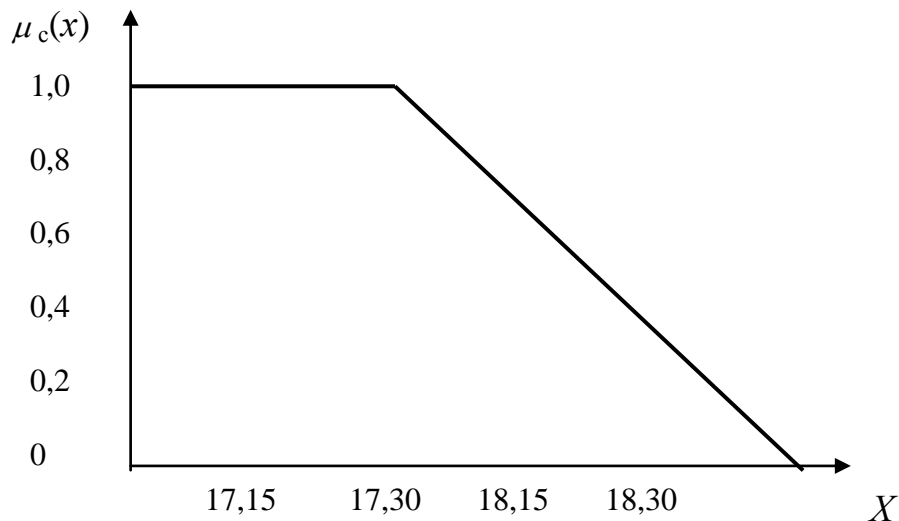
Рис. 3.1. Функція приналежності \mu_c(x) за параметром мінімального часу доставки вантажу X
