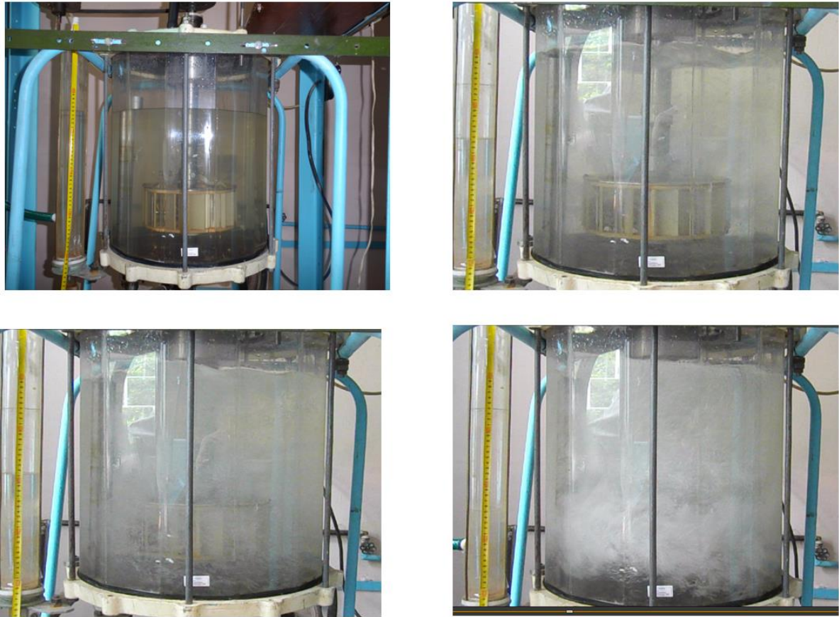
Рисунок 3.31 – Газорідинний апарат з самоусмоктуючою мішалкою і статором
