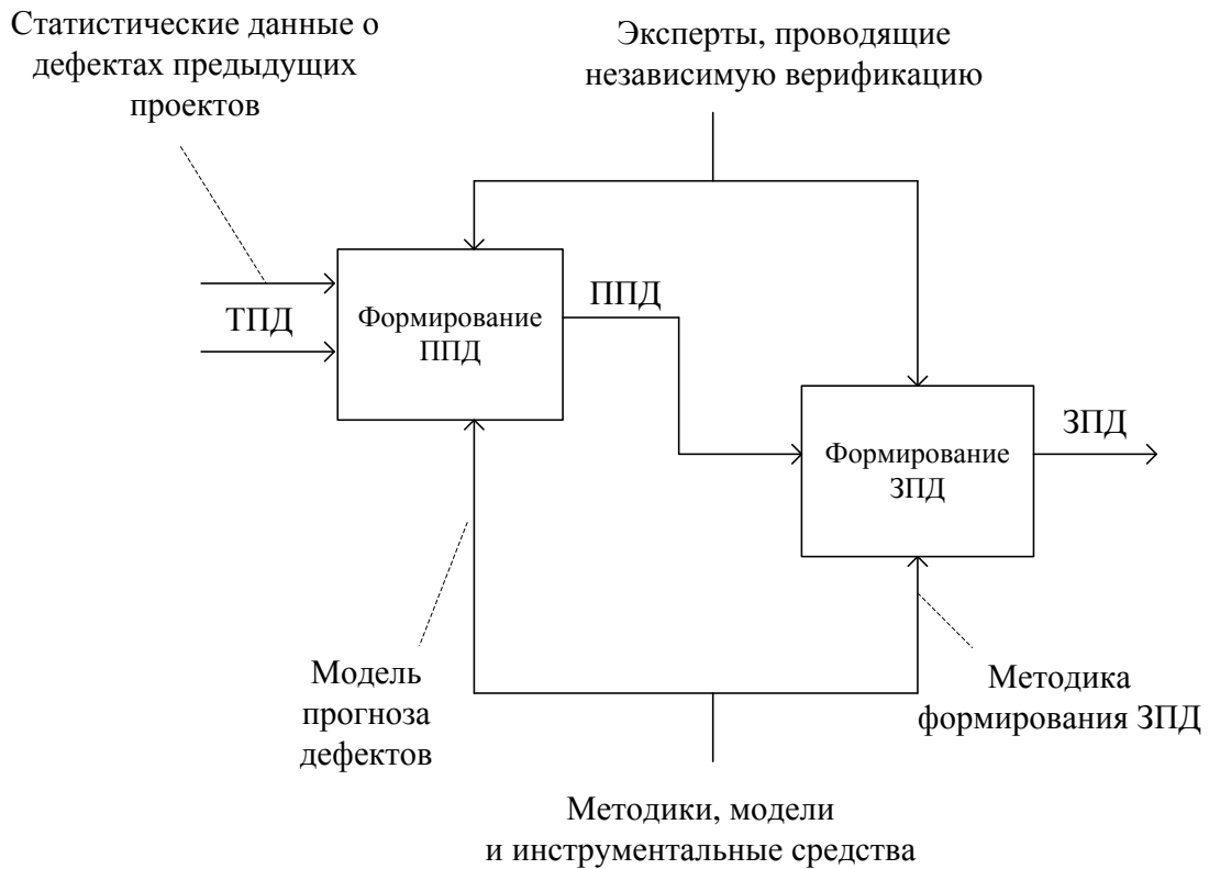
Рис. 3.3. Последовательность этапов в процедуре прогноза дефектов
