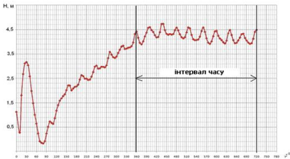
Рисунок 4 – Осереднення параметрів шнекової ступені за даними розрахунку (на прикладі напору)
