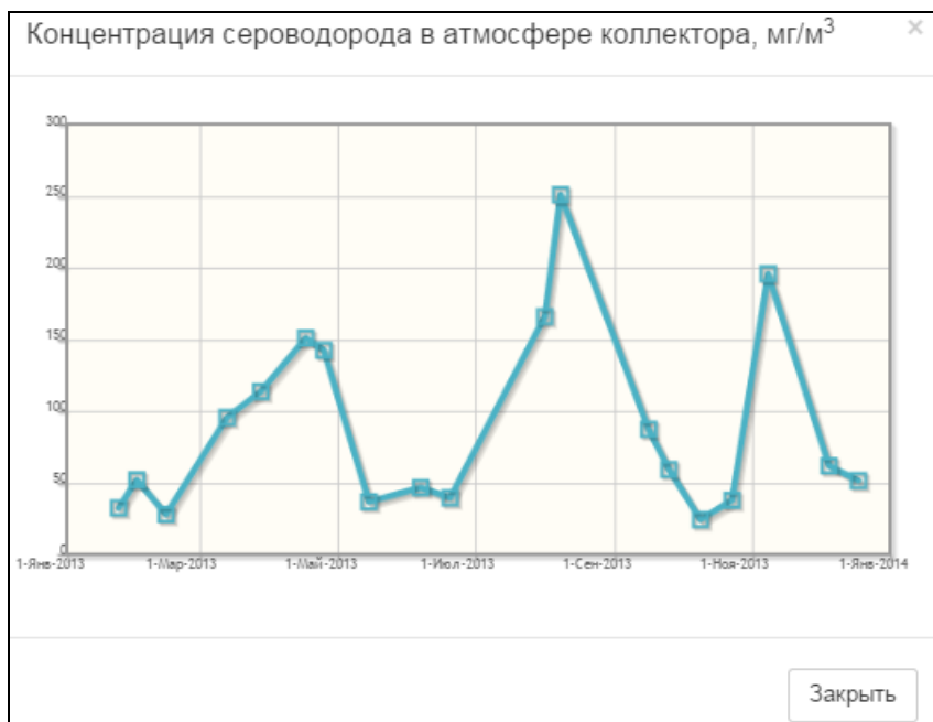
Рисунок 5.10 - Графік викиду H_2S в атмосферу підсклепіневого простору каналізаційного колектора [164]
