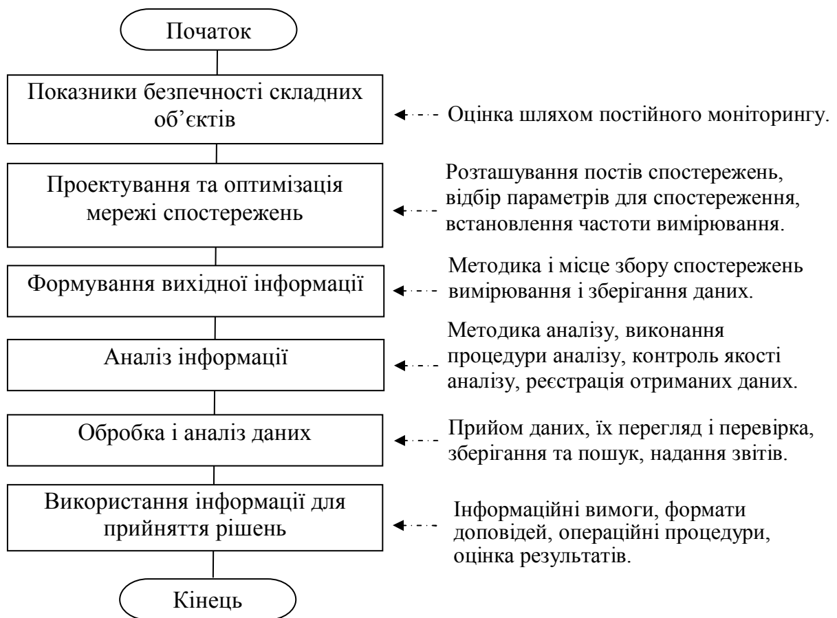
Рисунок 1.3 – Схема аналітичної оцінки стану систем і засоби її забезпечення
