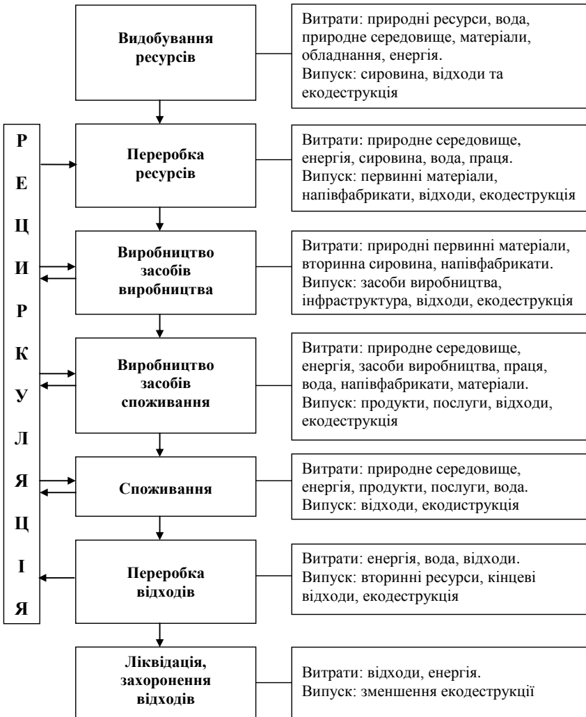
Рис. Б.1. Основні складові витрат-випуску на етапах циклу «виробництво – споживання – утилізація» інновації [210]
