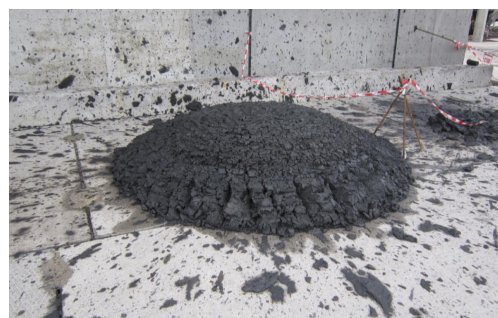
б – Вигляд осаду центрифуги ОГШ 461Л-01 на промисловому майданчику (середня вологість 30%)
