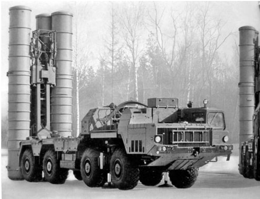
Рисунок 1.3 – Додаткова пускова установка 5П85Д зенітної ракетної системи С-300-ПС.
