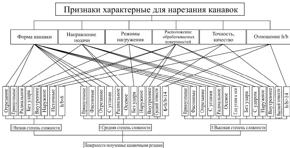
Рисунок 2 – Классификация поверхностей, обрабатываемых канавочными резцами
