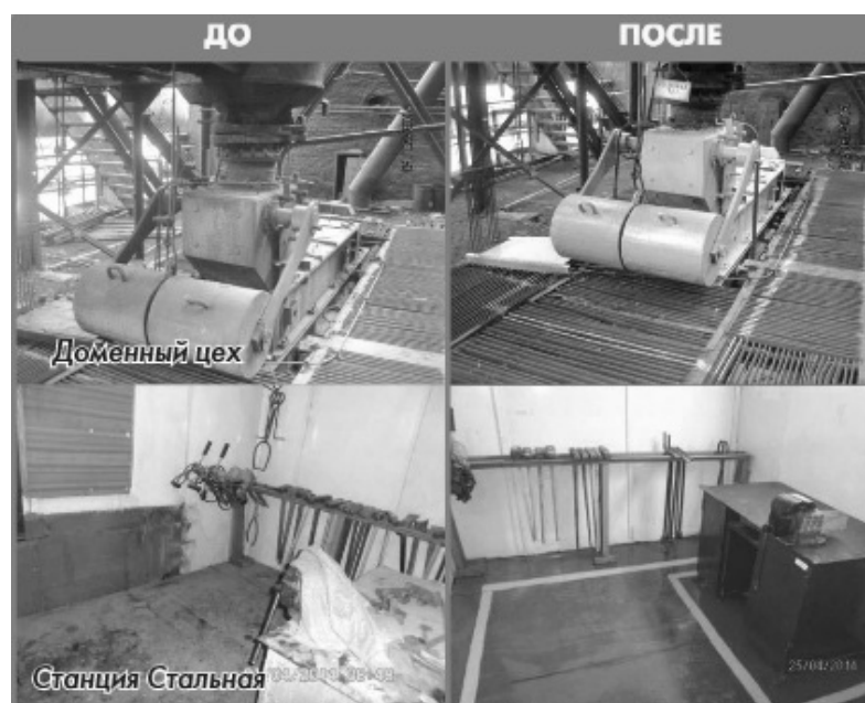
Рис. 11.5. Помещения заводских подразделений «до» и «после» внедрения системы «5S»
